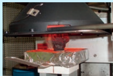
Las probetas de PVC deben aumentar su espesor inicial un 800% como mínimo para obtener la marca NF Me
