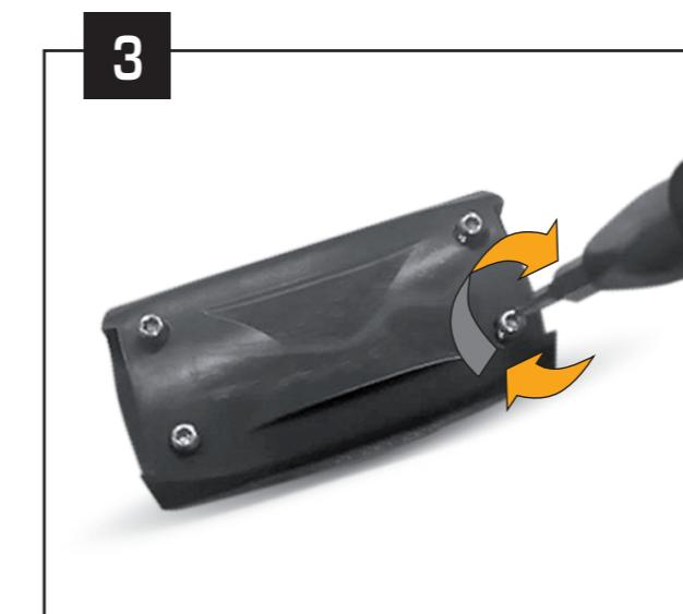
Desatornillar los 4 tornillos de la tapa para extraer la pila.
