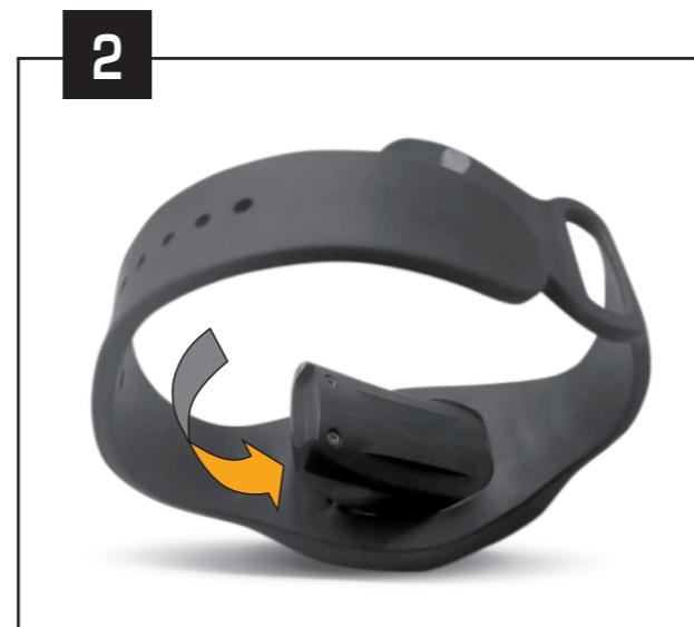
Flexionar para extraer el contenedor de la pila.
