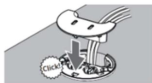
12. Ordenar el cableado saliente para colocar la salida de cableado a través del sistema de guiado:
