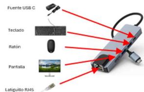
5. Realizar la conexión USB C “macho-hembra” entre el dock y el conector habilitado en el envolvente:
