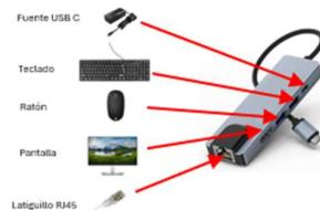
5. Realizar la conexión USB C “macho-hembra” entre el dock y el conector habilitado en el envolvente:
