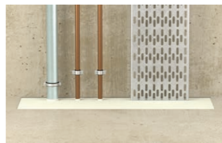
Paso de instalaciones mixtas a través del suelo
