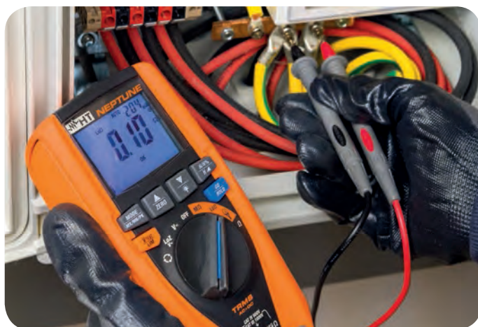
Continuidad de los conductores de protección.
