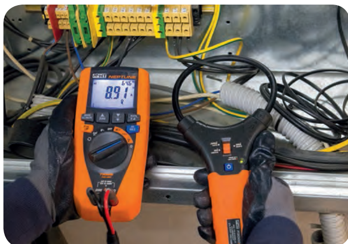
Medida de corriente mediante transductor flexible (F3000U opcional)
