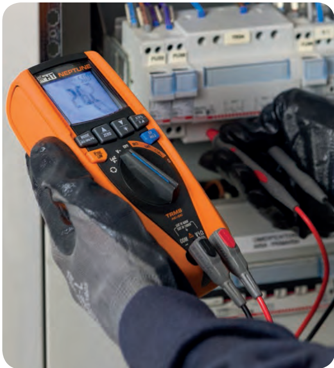
Medida de tensión con puntas de prueba.
