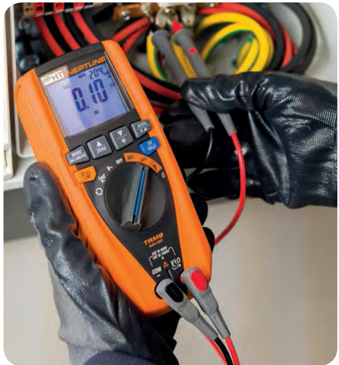
Continuidad de los conductores de protección a 200mA.
