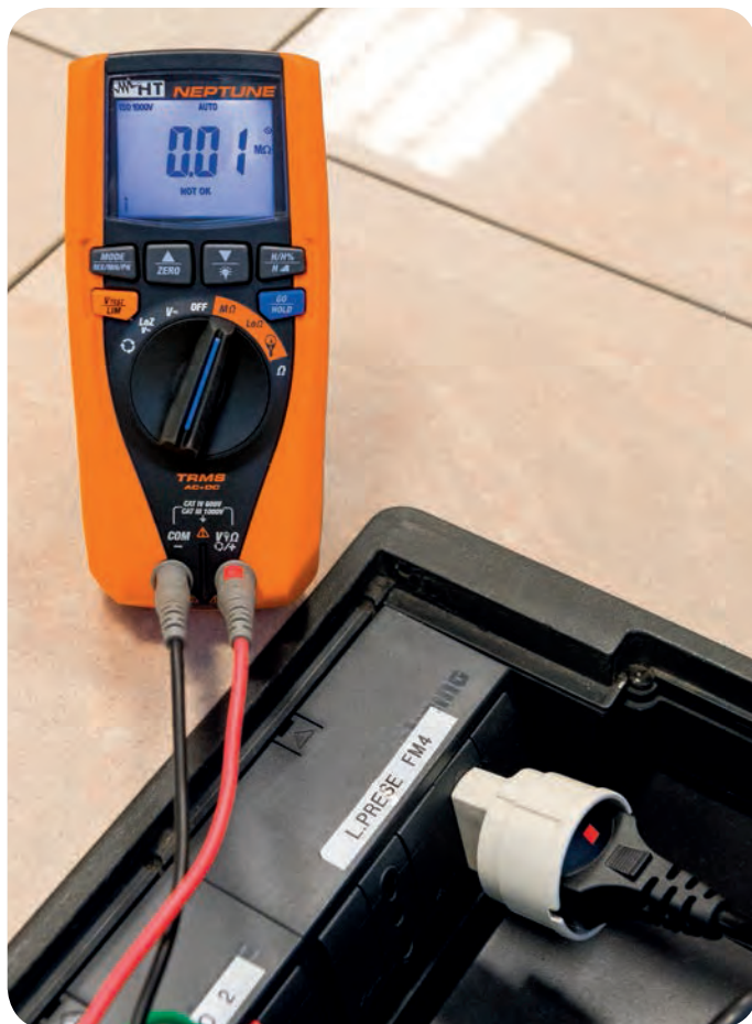
Medida Resistencia de Aislamiento (Adaptador Schuko C2065 opcional).
