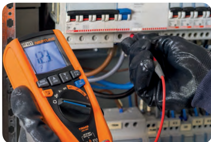
Medida del sentido cíclico de las fases con una única punta de prueba.
