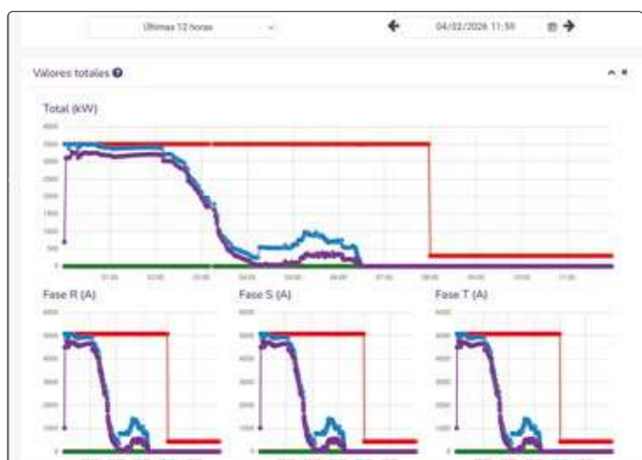
Balanceo de potencia que permite integrar cargadores de diferentes fabricantes, con flexibilidad para diferentes niveles de potencia en distintas franjas horarias, captura de datos de consumos de edificio y generación fotovoltaica para gestión dinámica avanzada.
