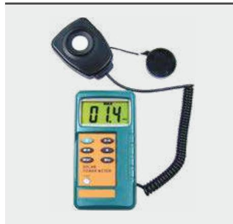
**Multímetro fotovoltaica / Medidor de irradiancia**
