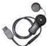
Sonda luxómetro LP-10B con clavija WS06
