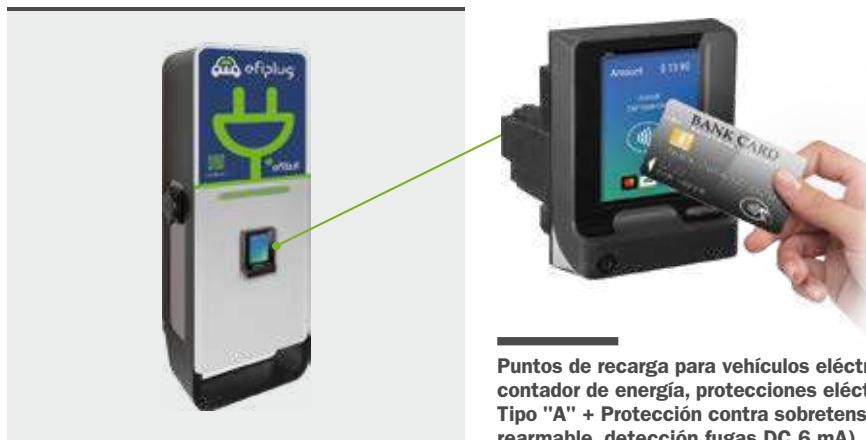
**Puntos de recarga para vehículos eléctricos simples y dobles, tipo poste con OCPP dotados de contador de energía, protecciones eléctricas según normativa ITC-BT-52: automático + Diferencial Tipo "A" + Protección contra sobretensiones transitorias y permanentes (opcional RFID, diferencial rearmable, detección fugas DC 6 mA). Con sistema de pago mediante tarjeta contactless "CardPlay"**
