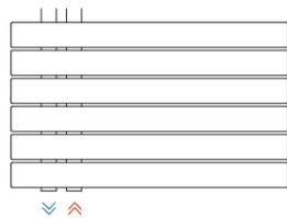
Conexión 50 mm con colectores en el lado izquierdo (conexión estándar, Cód. SN)
