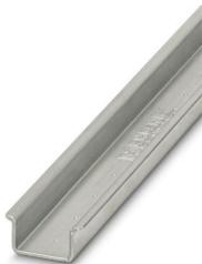
Carril simétrico sin perforar, Variante de embalaje con 10 unidades (20 m), según EN 60715, material: Acero, galvanizado, pasivado de capa gruesa, Perfil estándar 2,3 mm, color: plateado
