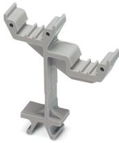
Soporte para señalización, Insertable en las bornas de conexión por resorte ST 2,5, rotulable con UC-TM 5, UC-TMF 5, UCT-TM 5, UCT-TMF 5, ZB 5 o ZBF 5, gris, sin rotular, clase de montaje: enclavar, altura del campo de texto: 10,5 mm, anchura del campo de texto: 5 mm
