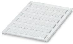
Marcador para bornes, disponible: por esteras, blanco, rotulado según las indicaciones del cliente, clase de montaje: encajar en ranura para índice alta, para ancho de borne: 5,2 mm, Número de índices individuales: 72, altura del campo de texto: 10,5 mm, anchura del campo de texto: 4,6 mm
