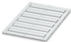
Marcador para bornes, disponible: por esteras, blanco, rotulado según las indicaciones del cliente, clase de montaje: encajar en ranura para índice plana, para ancho de borne: 5,2 mm, Número de índices individuales: 72, altura del campo de texto: 4,7 mm, anchura del campo de texto: 4,4 mm
