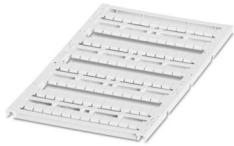
Marcador para bornes, Estera, blanco, sin rotular, rotulable con: BLUEMARK E. CARD, BLUEMARK ID COLOR, BLUEMARK ID, BLUEMARK CLED, PLOTMARK, CMS-P1-PLOTTER, clase de montaje: enclavar, para ancho de borne: 5,2 mm, Número de índices individuales: 96, altura del campo de texto: 5,1 mm, anchura del campo de texto: 4,6 mm
